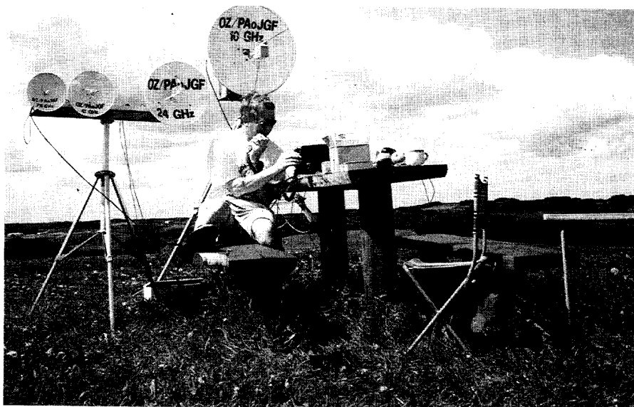
Fig. 2. Het station OZ/PA0JGF in actie. Op de standaard van links naar rechts de antennes voor 76, 47, 24 en 10 GHz.
